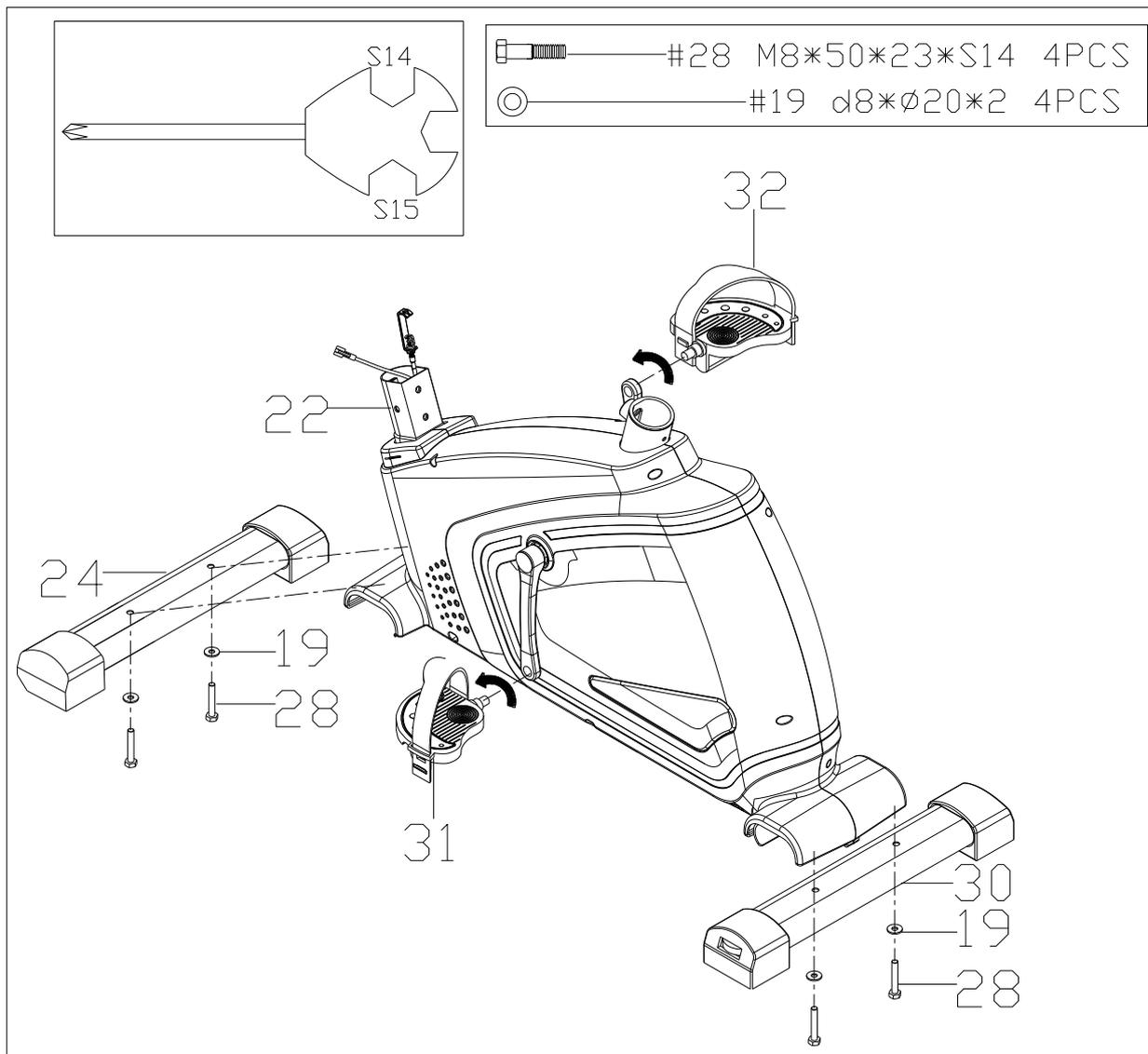
1. Присоедините переднюю (24) и заднюю ножки (30) на главной раме (22) с помощью болтов (28) и шайб (19)
