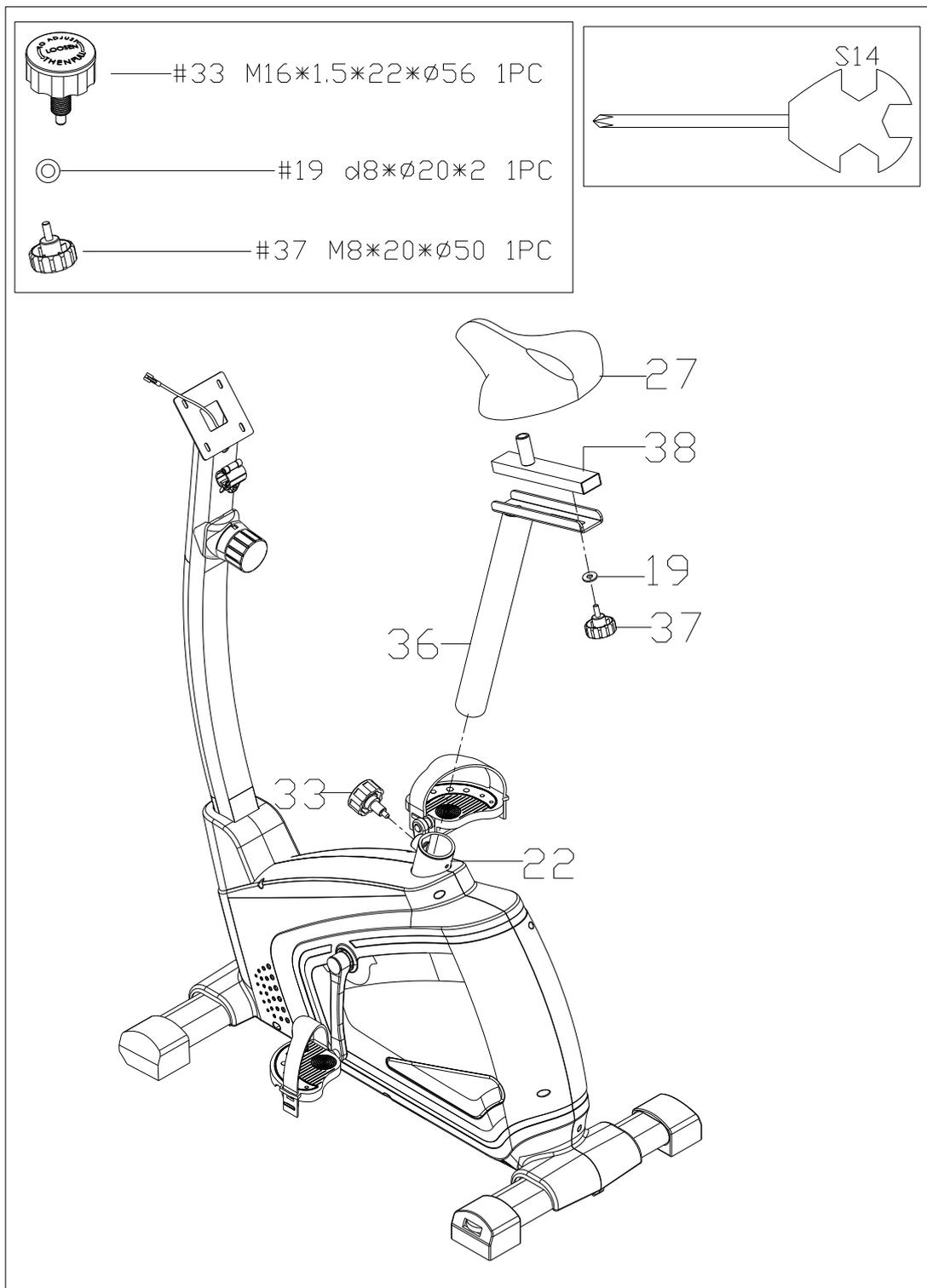
1. Вставьте раму сиденья (36) в трубу сиденья главной рамы (22), зафиксируйте ее с помощью закрутки (33)
