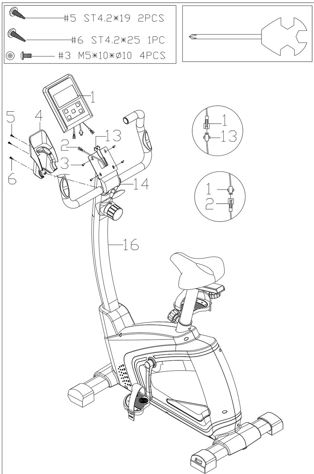
1. Соедините компьютерный кабель с кабелем 1 (2), соедините компьютерный кабель кабелем пульсосъемника, зафиксируйте компьютер (1) на стойке (16).
